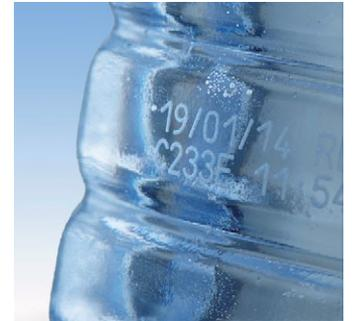
标识时间通常由去掉从一个字符跳转到下一个字符所用的时间以外的实际时间构成。优化实际标识时间与跳转时间是最大限度地延长可用标识时间的一种方法。跳转时间处于闲置状态，包括跳转、等待、以及振镜减速和加速时间。
